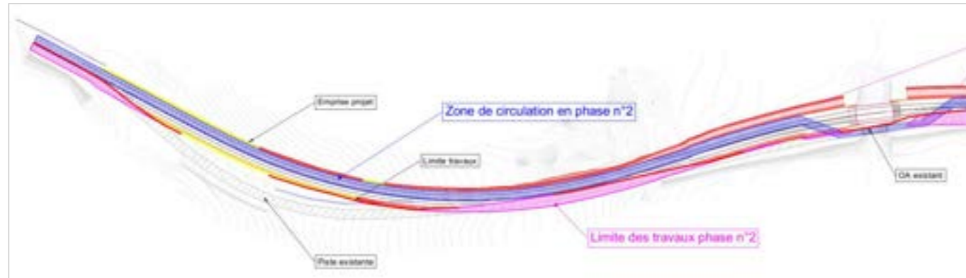
Figure 16 : Différentes zones de travaux en phase n°2 – Côté Ouest
