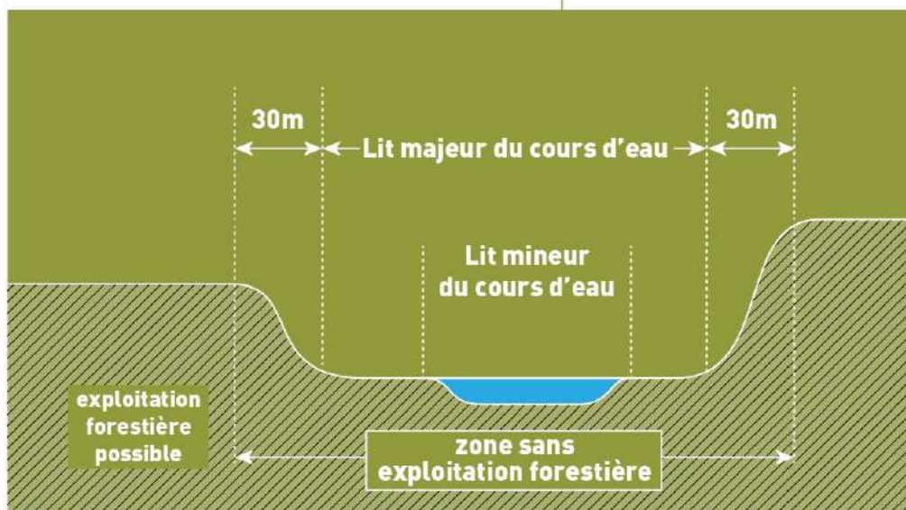
Figure 5 : Schéma représentant la zone tampon à respecter de part et d'autre du lit majeur des cours d'eau dont le lit mineur a une largeur inférieure à 4 m.
