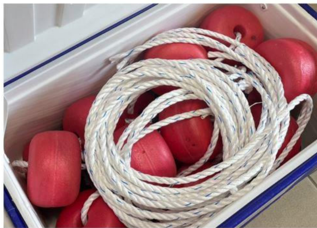
Flotteurs expérimentaux permettant la suppression des ralingues
